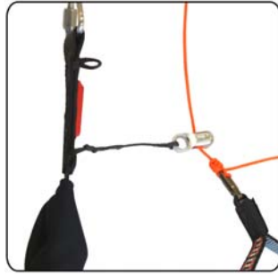
Position inférieure de la poulie de guidage du frein
