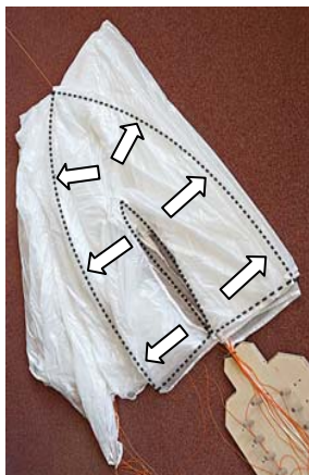
15) Devátý a desátý panel jsou rohové – rozloží si je napravo a nalevo tak, ať je jejich plocha napnutá a vyhlazená.
