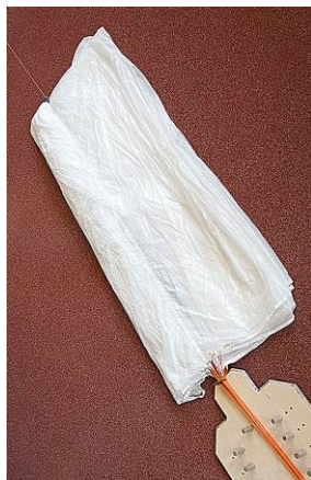
32) Levé panely podsuň pod střední část vrchlíku do pomyslného tvaru „S“ tak, že je přeložíš na třetiny.
