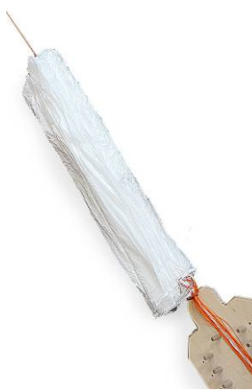
35) Vrchlík je složen na šířku vnitřního kontejneru.
