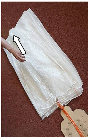
28) Horní okraj rohových panelů vytáhni nahoru. Tím se napne rohová šňůra.
