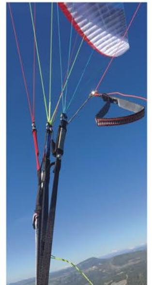
**3 bandas, A dividida, acelerador largo y buen agarre de la banda C para pilotar. La bóveda luce bien plana en el centro y marcada solo en los extremos, con un freno tenso por las anillas de fruncido.**
