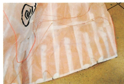
Bouts d'ailes non suspendus, sérieux galon, renforts sur les anneaux de freinage, et du gros travail de voilerie sur cette Eden 6 !
