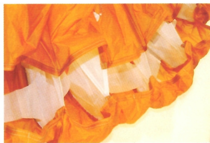
Sérieux travail de protection des joncs, pour un bord d'attaque sophistiqué et très structuré.
