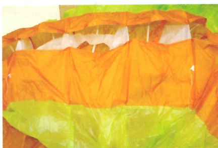
La Paradis, le jaune est du tissu léger, structure interne allégée également. Les joncs d'extrados en milieu de cellules s'appellent des Rigifoils, ils étaient déjà présents sur les Magus de compétition. Pour l'anecdote, c'était une invention de Gin Seok Song et Peter Recek avait judicieusement apposé un sticker « Rigifoils by Gin Gliders ».
