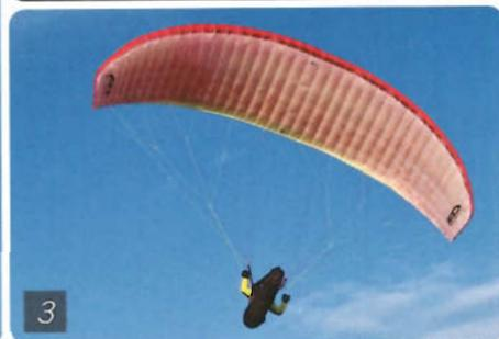
mag. Andererseits durch das von BGD bekannte Cord Cur Billow – jenem schiefen Segelschnitt an der Profilnase, das Faltenbildung an den Rippen weitgehend verhindern soll. Sehr markant fällt übrigens die Shark Nose am Epic aus – das Untersegel ist deutlich abgesetzt, um konstant hohen Innendruck über alle Anstellwinkel zu generieren.
